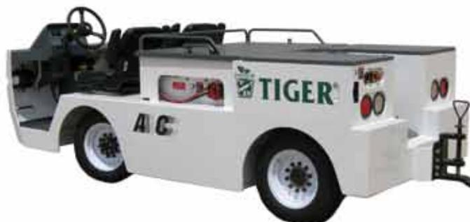
Новый электрический тягач Tiger TC-50E оснащен электромотором переменного тока с тяговым усилием от 1361 до 2268 кг.
